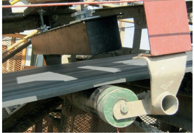
Ultraschall-Sensorfeld mit stabilisierender Tragrolle
